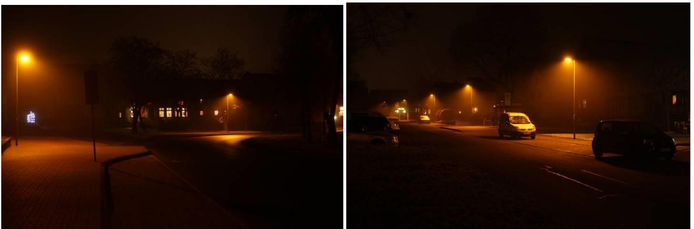
Der Anger in Rasdorf ist mustergültig mit voll abgeschirmten gelben LED-Leuchten (nach dem Spektrum vermutlich Innolumnis GoldenOrange) mit geringen Blauanteilen beleuchtet, die Durchgangsstraßen mit warmweißen LED-Leuchten, allerdings dort mit relativ hoher Beleuchtungsstärke.
