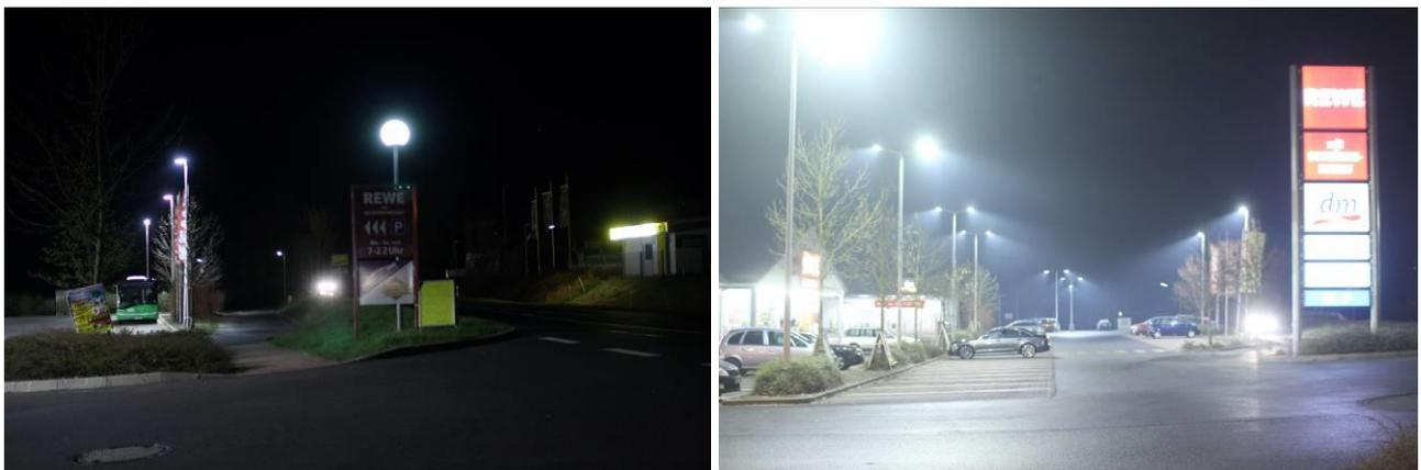
Parkplatzbeleuchtung eines Supermarktes in Hilders vor der Umrüstung (links, Aufnahme vom 22.04.2012) vermutlich mit Halogenmetalldampf lampen und danach (rechts) mit 4000 K LED. Die Aufnahmedaten sind exakt identisch.
